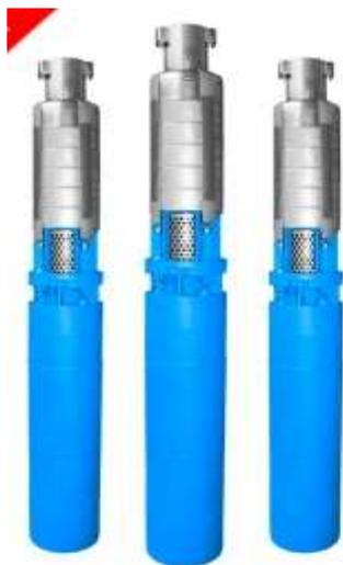
Насосы серии 2FRS предназначены для подъема воды, с массовой долей твердых механических примесей – не более 0,02% с размером 0,5 мм, из артезианских скважин. Водородный показатель pH 5,5-9,5.
